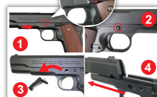
1. Maintenir la culasse en arrière. 2. Pousser sur l'arrêteur de culasse. 3. Retirer l'arrêteur de culasse. 4. Retirer la culasse.
