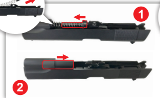
1. リコイルスプリングとリコイルガイドロッドを外してください。 2. スプリングプラグを外してください。
