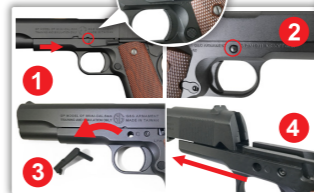
1. (図のとおり)、スライドを後ろにずらして切り欠きをあわせませう。 2. スライドストップを押してください。 3. スライドストップを抜き取ります。 4. 前にずらしてスライドを抜きます。
