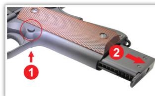
1. マガジンキャッチボタンを押してください。 2. マガジンを取り出してください。
